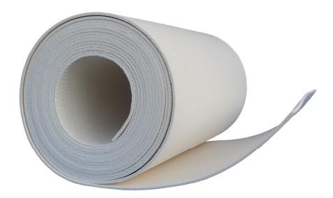
Papír se vyrábí z keramických vláken na papírenských strojích a spolu s organickými pojivy tvoří pevný materiál. Je určen především k výrobě tvarových těsnění.
